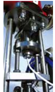
Abbildung 2: Temperaturmesssonde flexsens 100, seitlich ausbaubar, ohne dass das Ventil demontiert oder geöffnet werden muss.
