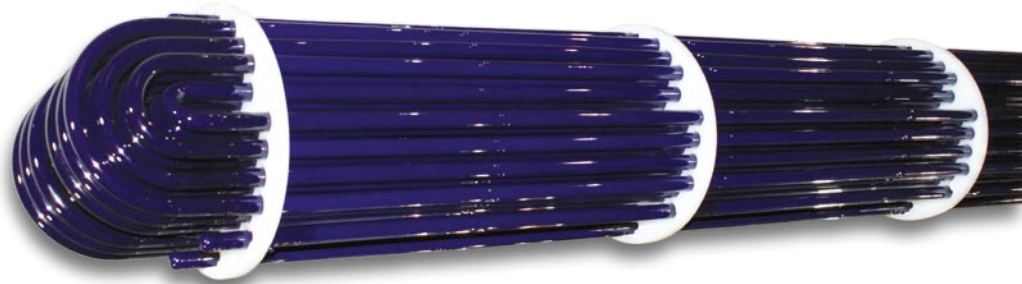
Abbildung 1: Ansicht eines PowerBaffles für einen 20.000 l emaillierten Rührbehälter mit einer Länge von 4400 mm
