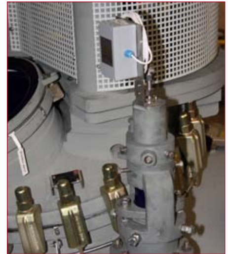
Abbildung 5: flexsens Temperatursensor, eingebaut in einen reemaillierten Stopfbuchs Stromstörer
