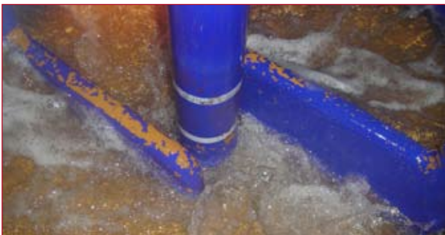
Abbildung 1: Blick in den AUREOMAT Reaktor nach abgeschlossener Goldfällung; gut erkennbar werden die signifikanten Goldmengen bis unter die Oberfläche »aufgeschlämmt«. Um Verschleiß zu vermeiden, ist der Apparat mit dem abrasionsbeständigen THALETEC ABRISIST emailliert
