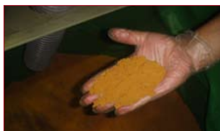
Abbildung 2: Im AUREOMAT mittels SEGTEC-Technologie gefällter Feingoldschwamm, ca. 100 kg, Feingoldqualität \geq 99,99\% . Gleichmäßig feinkörnige (sandähnliche) Struktur des Goldschwamms, welcher nach einem einfachen Waschschrift zum Beispiel in Feingoldbarren oder in eine andere kundenspezifische Produktform gegossen wird
