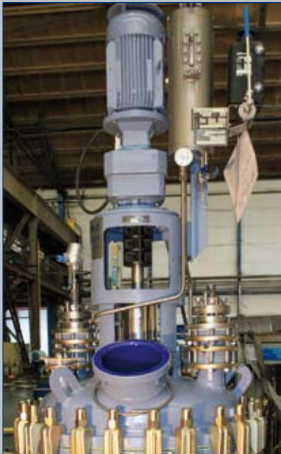
Emallierter Rührbehälter mit SEGTEC Begasungssystem für das AUREOMAT-Verfahren, emalliert mit dem verschleißfesten THALETEC Abrisist-Email
