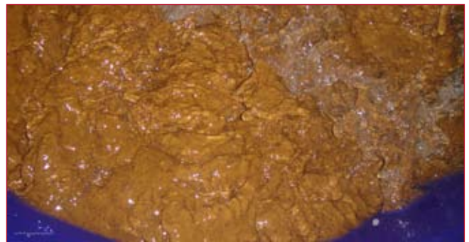
Abbildung 1: Blick in den AUREOMAT Reaktor nach abgeschlossener Goldfällung; gut erkennbar werden die signifikanten Goldmengen bis unter die Oberfläche »aufgeschlämmt«. Um Verschleiß zu vermeiden, ist der Apparat mit dem abrasionsbeständigen THALETEC ABRISIST emailliert
