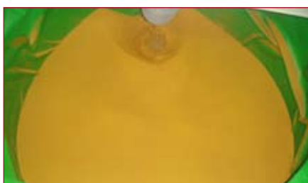
Abbildung 2: Im AUREOMAT mittels SEGTEC-Technologie gefällter Feingoldschwamm, ca. 100 kg, Feingoldqualität \geq 99,99\% . Gleichmäßig feinkörnige (sandähnliche) Struktur des Goldschwamms, welcher nach einem einfachen Waschschrift zum Beispiel in Feingoldbarren oder in eine andere kundenspezifische Produktform gegossen wird
