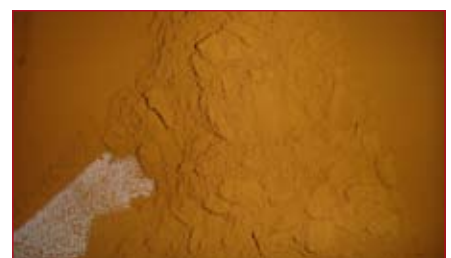
Abbildung 2: Im AUREOMAT mittels SEGTEC-Technologie gefällter Feingoldschwamm, ca. 100 kg, Feingoldqualität \geq 99,99\% . Gleichmäßig feinkörnige (sandähnliche) Struktur des Goldschwamms, welcher nach einem einfachen Waschschrift zum Beispiel in Feingoldbarren oder in eine andere kundenspezifische Produktform gegossen wird
