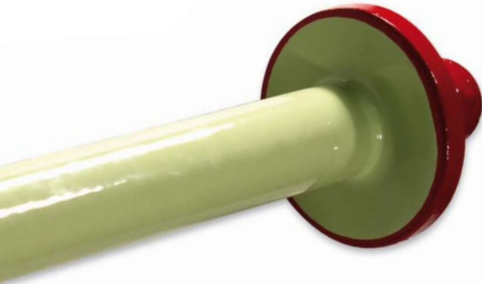
Abbildung 2: Temperatursensor mit eingestecktem PT100, emailiert mit THALETEC BIORESIT. Das Bauteil ist ca. 1.000 mm lang und hat einen Durchmesser von 40 mm
