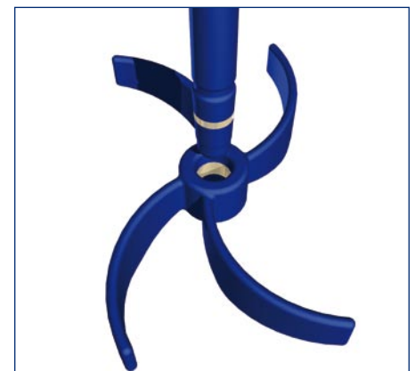
Abbildung 4: Elektrische leitfähige Verbindung zwischen Rührwelle und Turbine mit Hilfe von Hastelloy-Ringen auf Welle und Turbinen-Nabe.
