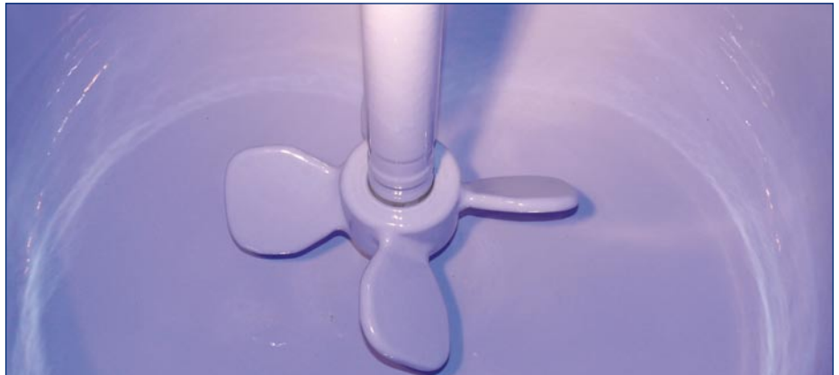
Abbildung 6: Turborührer in einem Pharma-Rührbehälter – einer der vielen THALETEC Speziallösungen zur Prozessoptimierung
