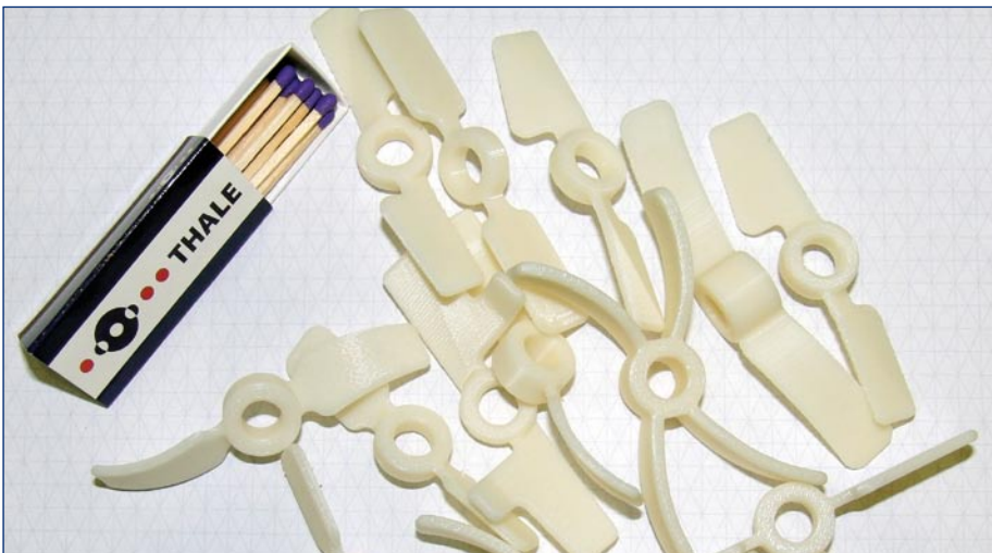
Abbildung 7: (siehe Text) Beispiel für maßstabgerecht verkleinerte THALETEC Rührorgane, hergestellt aus ABS-Kunststoff mit einem Rapid-Prototyping-System
