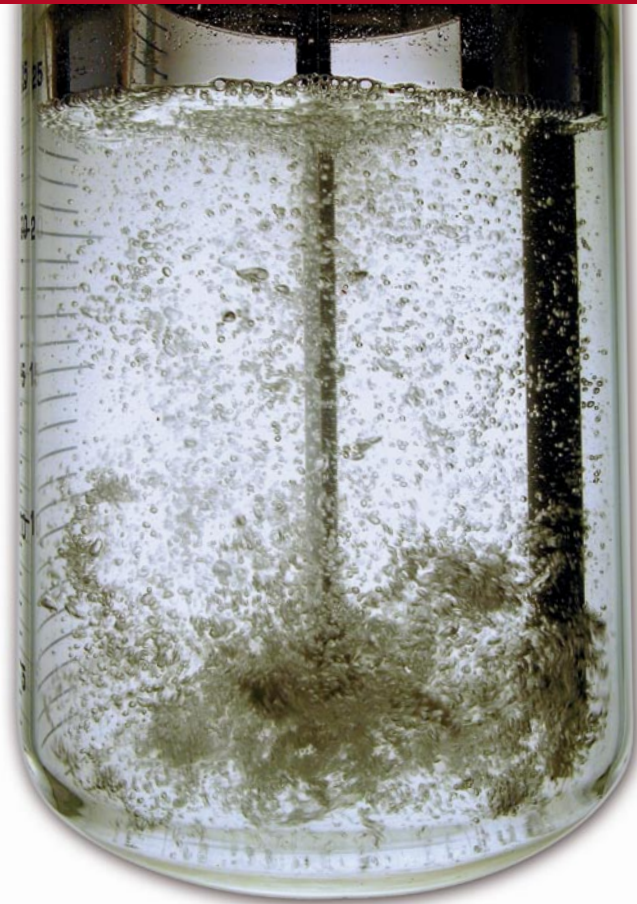
Abbildung 4: Verteilung von Gas durch eine THALETEC DCT-Turbine in einem Versuchsbehälter
