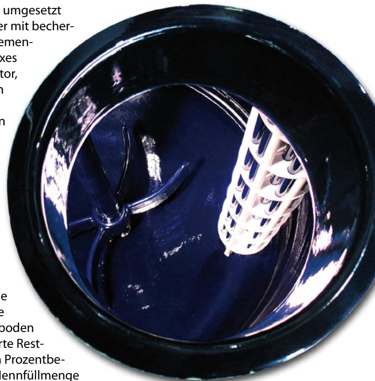
Abbildung 3: Der PowerBaffle, ein emaillierter U-Rohr Wärmeaustauscher anstelle des Stromstörers, mit integrierter Temperaturmesssonde, ersetzt den konventionellen Stromstörer komplett und kann in bestehende Apparate nachgerüstet werden
