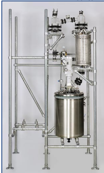
Abbildung 2: Emaillierter Apparat, eingebunden in eine GMP-gerechte Glasanlage für die Entwicklung neuer Wirkstoffe
