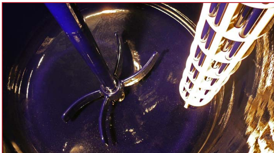
Der PowerBaffle ist natürlich mit Temperaturmessung ausgestattet
