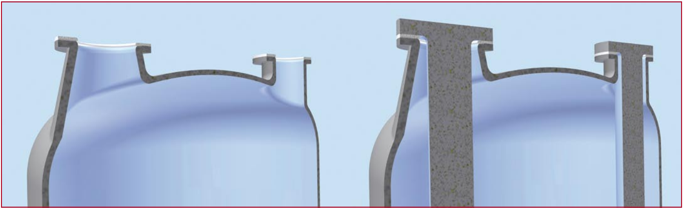
Abbildung 2: Schnitt durch einen konischen und einen konventionellen Stutzen, ohne und mit Einbauteil.
