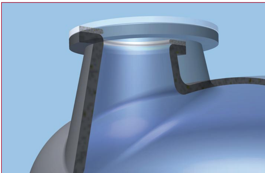
Abbildung 1: Behälterboden mit einem konischen Stützen. Der Öffnungswinkel des Stützenhälses beträgt hier etwa 12°.
