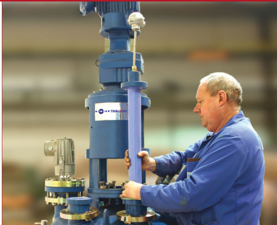
Abbildung 1: THALEMAIL Stromstörer in hellblauem Pharma-Email mit eingestecktem Temperatursensor PT100 (TS-Sonde) während der Montage
