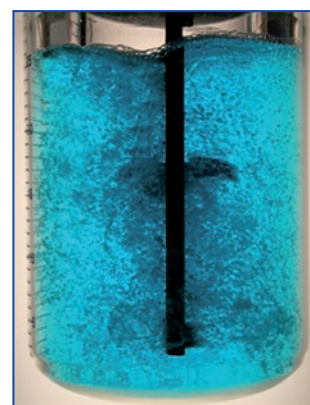
Gasdispersion im Versuchsapparat Gas dispersion in lab scale reactor
